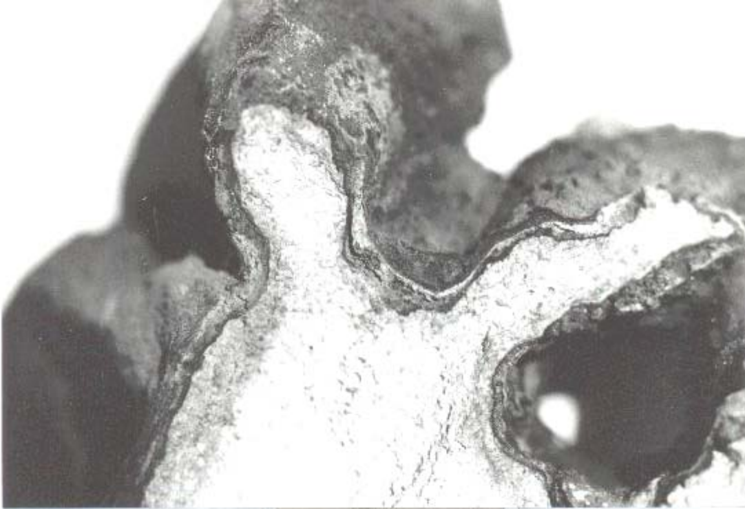
F 3 Diese Bruchfläche zeigt deutlich eine ca. 1 mm dicke Schmutz-/Gipskruste auf der Kalksteinoberfläche.
